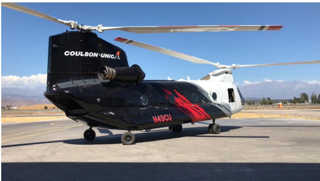
Foto: CH-47D Chinook de Coulson, para combate nocturno, con estanque RADS en el interior de la aeronave de 15.000 litros de agua.
